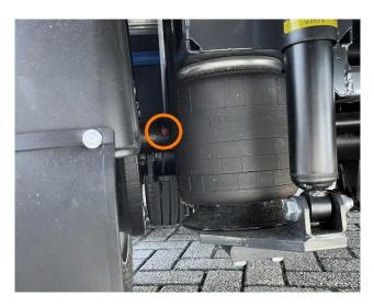
Position Schmiernippel an der Ankerplatte, links und rechts
