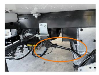
Überprüfen Sie, ob die Feststellbremse des Aufliegers, die über die Spindel auf der Fahrerseite betätigt wird, gelöst ist
