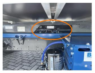
• Überprüfen Sie, ob die Sattelkupplung auf der Beifahrerseite vollständig eingefahren und mit dem Verriegelungshebel gesichert ist
