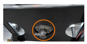
Überprüfen Sie die Verschraubung der Kingpin-Schraube. Anzugsdrehmoment 130 Nm
