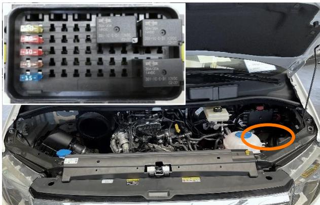
• Die IBS-Sicherungen befinden sich im Sicherungskasten des IBS-Computers im Fahrzeug wie abgebildet
