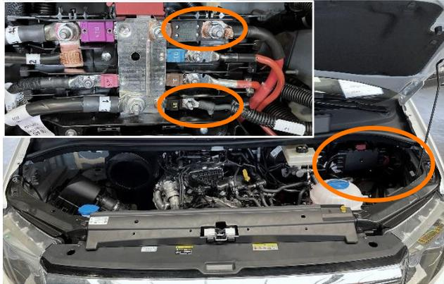
• Die Hauptsicherungen befinden sich im Sicherungskasten des Fahrzeugs wie abgebildet
